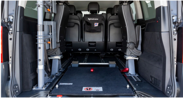
Sistema EASYFLEX, que permite abatir la rampa y disfrutar de un amplio maletero.
